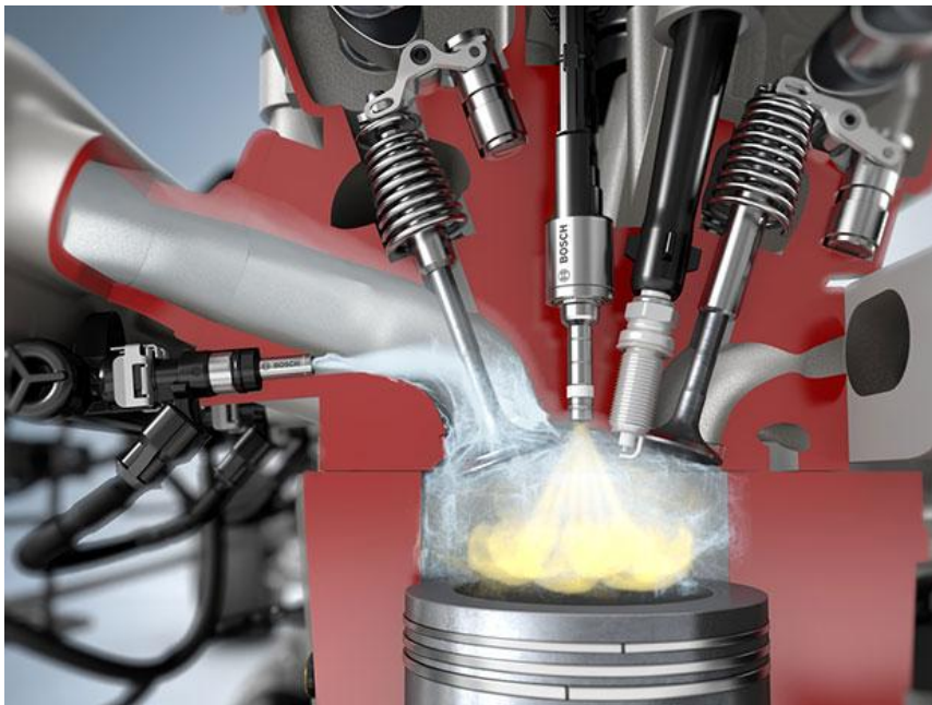
Obrázek 24: Princip vstřikování vody do sacího kanálu hlavy válců [56]
