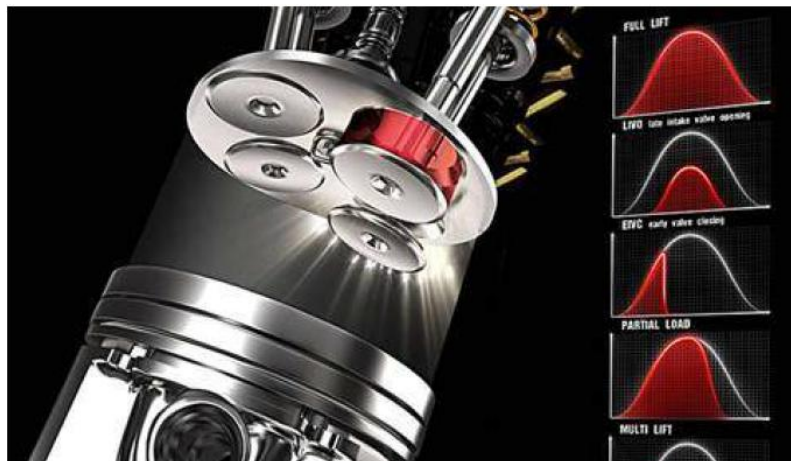
Obrázek 23: Variabilní časování motoru Fiat MultiAir [53]
