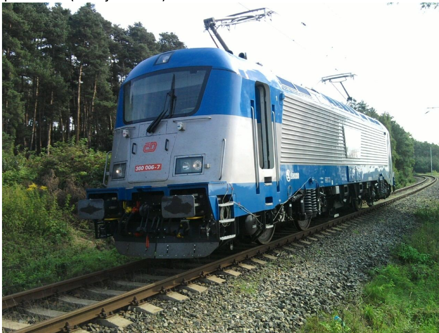
Obrázek 6 Lokomotiva 109E (řada ČD 380 006-7) na malém zkušebním okruhu VUZ v Cerhenicích
