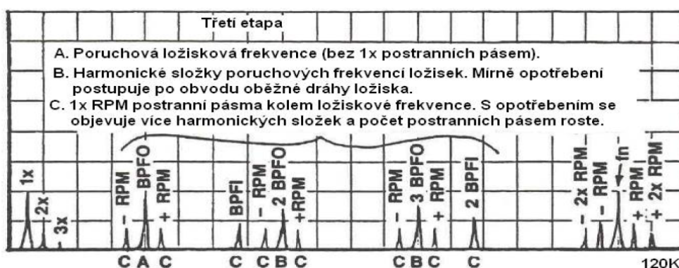
Obrázek 3.5: Ukázkové frekvenční spektrum vadného ložiska v závěru jeho životnosti [2].
