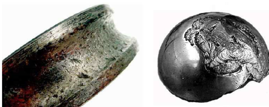
Obrázek 3.2: Pitting na valivém ložisku [2].
