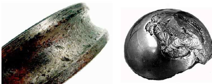
Obrázek 3.2: Pitting na valivém ložisku [2].
