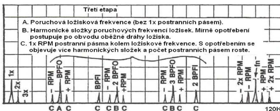
Obrázek 3.5: Ukázkové frekvenční spektrum vadného ložiska v závěru jeho životnosti [2].
