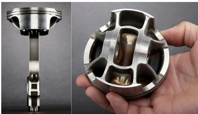
Obr. 34 Píst, který používaly motory F1.[42]
