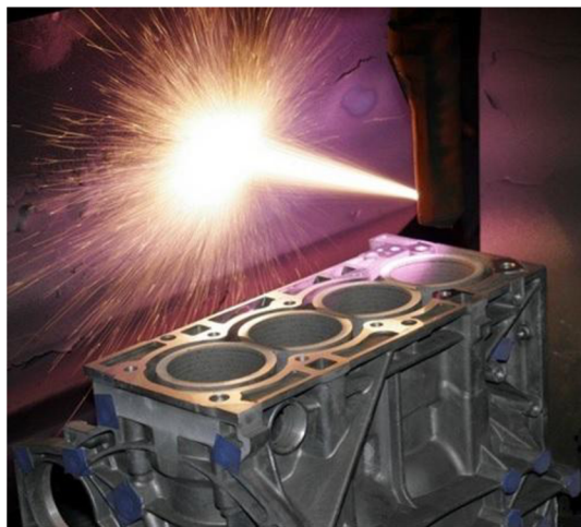
Obr. 32 Metoda PTWA, která našla své uplatnění v modelové řadě motorů Ford EcoBoost. [27]
