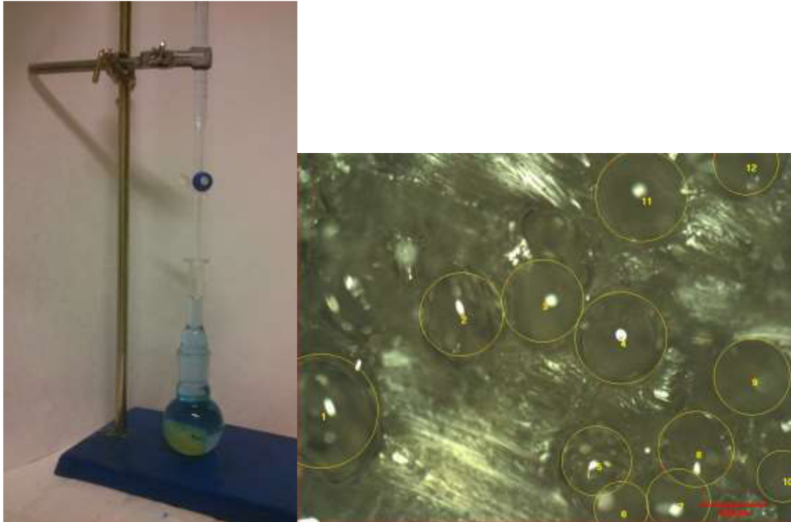
Obr. 20: Stanovení objemu vzorku polyuretanové matrice (vlevo) a stanovení pórovitosti polyuretanové matrice pomocí konfokálního mikroskopu LEXT OLS 3000 (vpravo).
