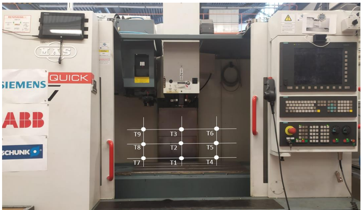
Obr. 21 Polohy jednotlivých testov – meranie 1
