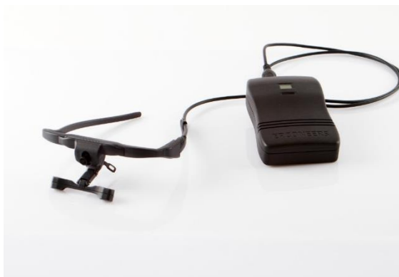
Obr. č. 2 – Eeyetracker Dikablis Glasses [43]
