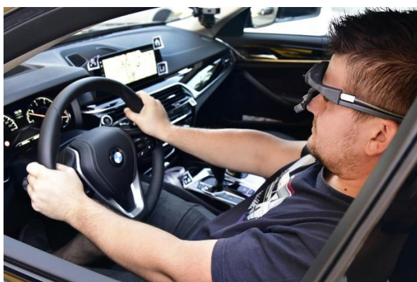
Obr. č. 10 – Řidič s eyetracker Dikablis Glasses [49]
