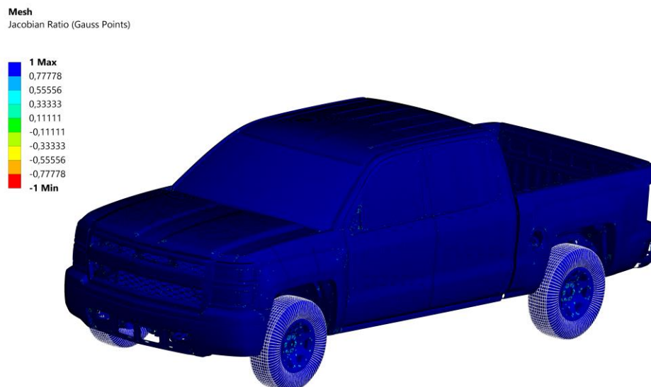
Obr. 27: Jacobian Ratio (Gauss Point) – znázornění
