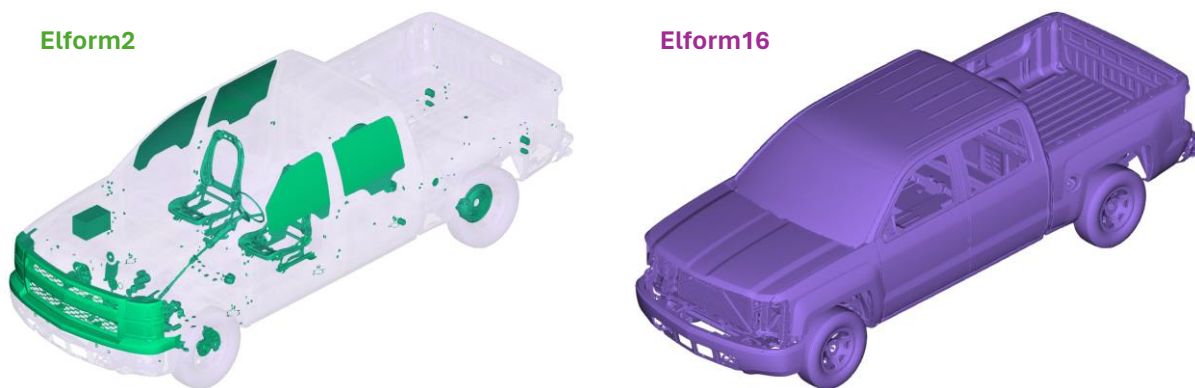
Obr. 88: Díly s formulací skořepinových prvků Elform 2 a Elform 16
