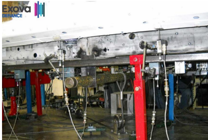
Obr. 10: Ohybový test: aplikace zatížení na zespodu rám [14]
