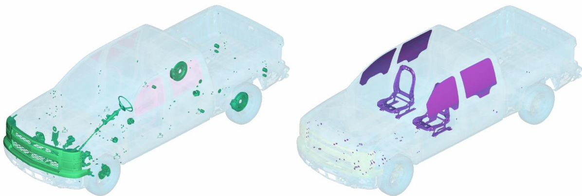
Obr. 13: Znáornění skořepinových prvků s formulací Elform 2 s 2 (vlevo) a 5 (vpravo) integračními body
