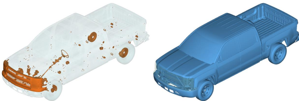
Obr. 89: Znárodnění dílů s dvěma integračními body oranžově a s pěti integračními body modře
