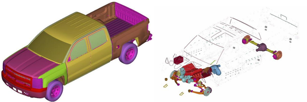
Obr. 17: Skořepinové prvky (vlevo), objemové prvky (vpravo)
