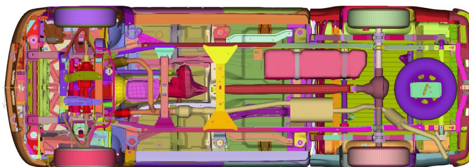
Obr. 12: Diskretizovaný model Chevrolet Silverado – pohled zespodu
