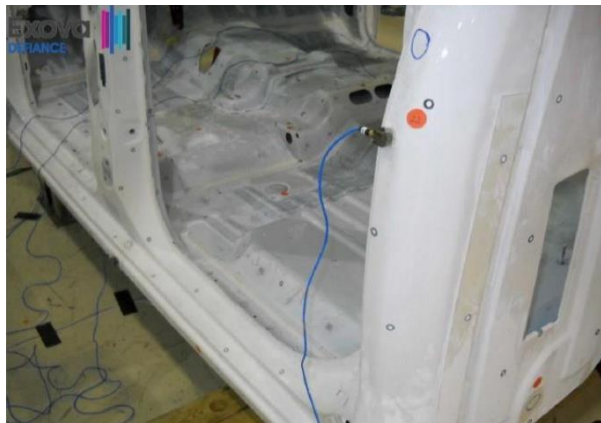
Obr. 7: Experimentální modální analýza – akcelerometr [14]
