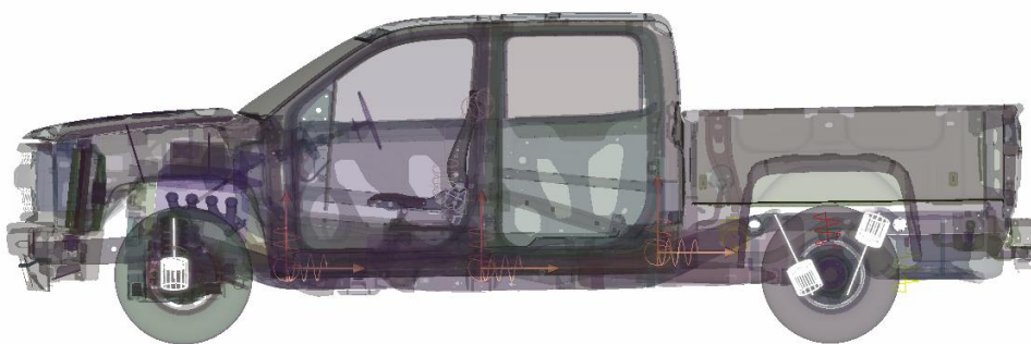
Obr. 20: Znáznornění prvku typu tlumič
