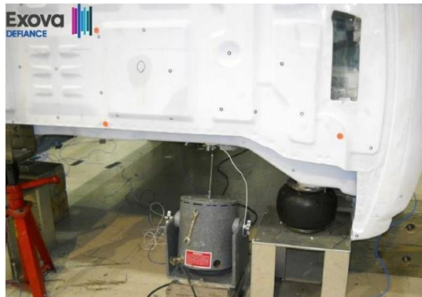
Obr. 6: Experimentální modální analýza. Uprostřed je budič vibrací a napravo vzduchový vak [14]
