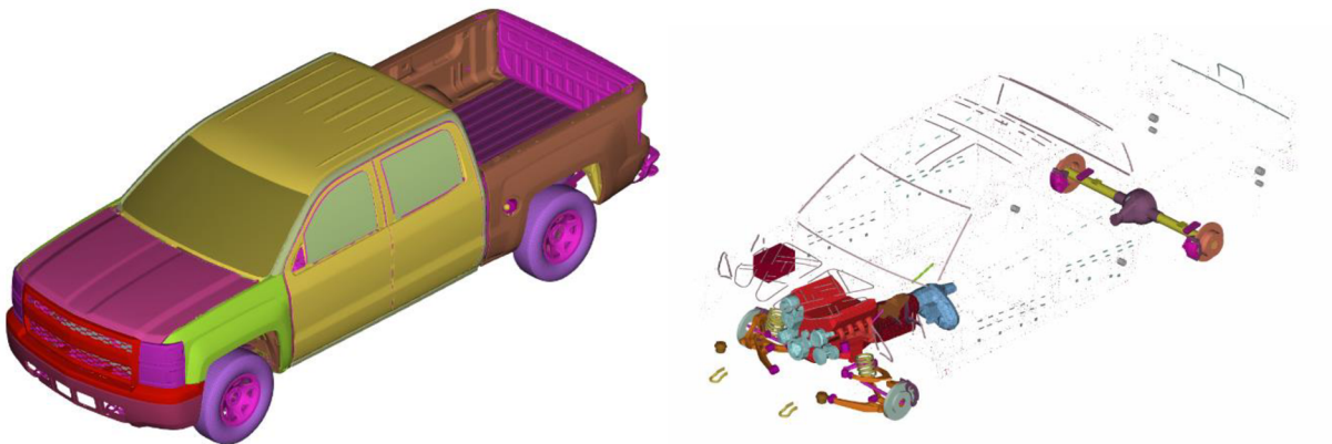
Obr. 17: Skořepinové prvky (vlevo), objemové prvky (vpravo)
