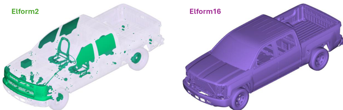
Obr. 88: Díly s formulací skořepinových prvků Elform 2 a Elform 16
