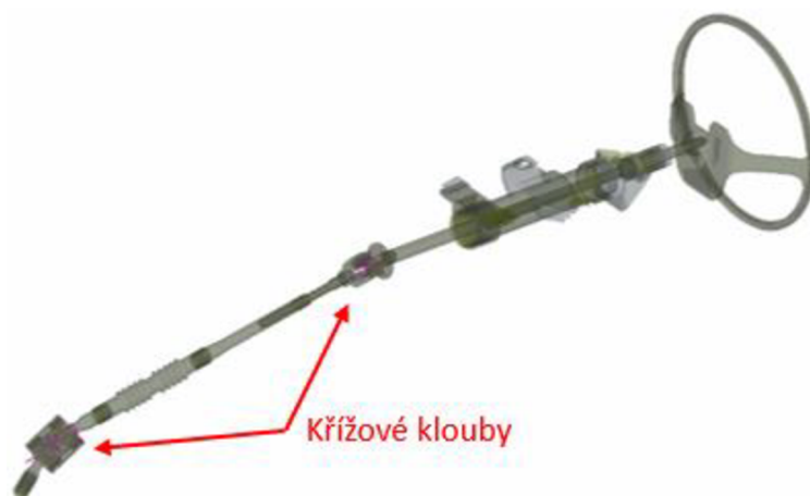
Obr. 32: Znázornění použití křížových kloubů
