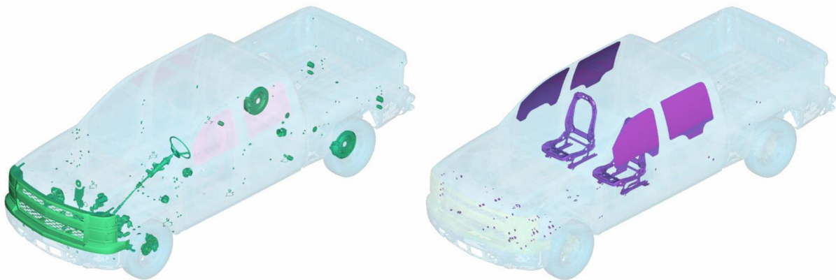
Obr. 13: Znárodnění skořepinových prvků s formulací Elform 2 s 2 (vlevo) a 5 (vpravo) integračními body
