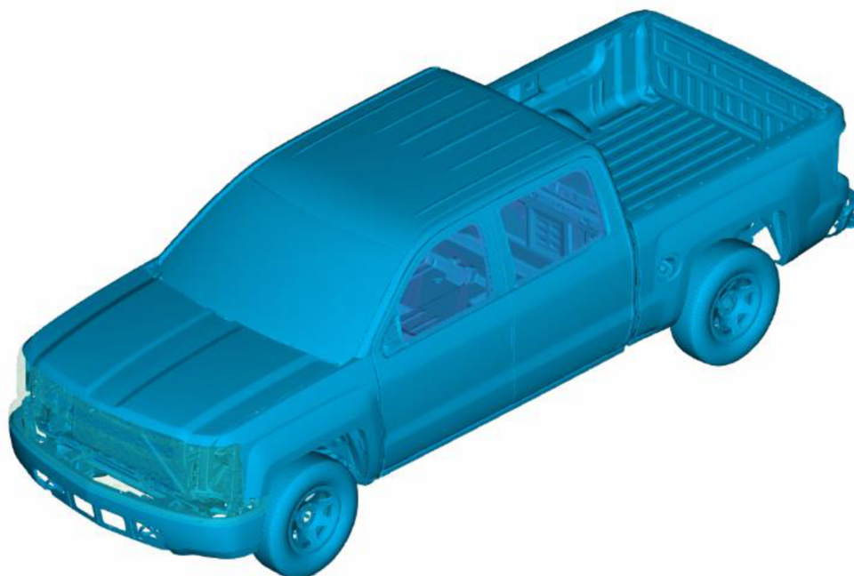
Obr. 14: Znárodnění skořepinových prvků s formulací Elform 16 a 5 integračními body
