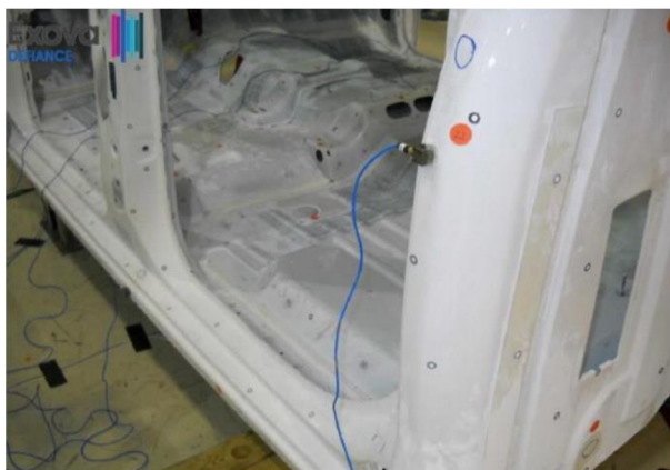
Obr. 7: Experimentální modální analýza – akcelerometr [14]
