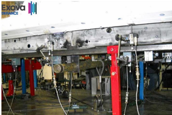
Obr. 10: Ohybový test: aplikace zatížení na zespodu rám [14]
