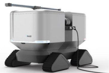
Nabíjanie batérie pomocou nabíjačky typu 2
