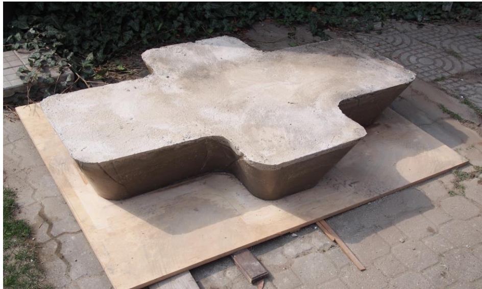
Obr. 44. Tvar betonu po rozebrání formy
