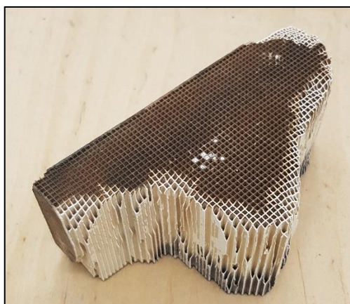
Obrázek 23 – Ukázka katalyzátoru na konci jeho životního cyklu
