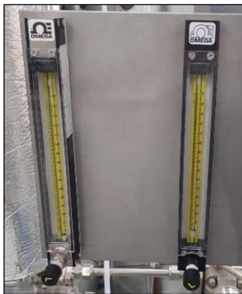
Obrázek 35 – Rotametry použité pro kontrolu dávkovaného množství \text{NH}_3 a \text{NO}_x
