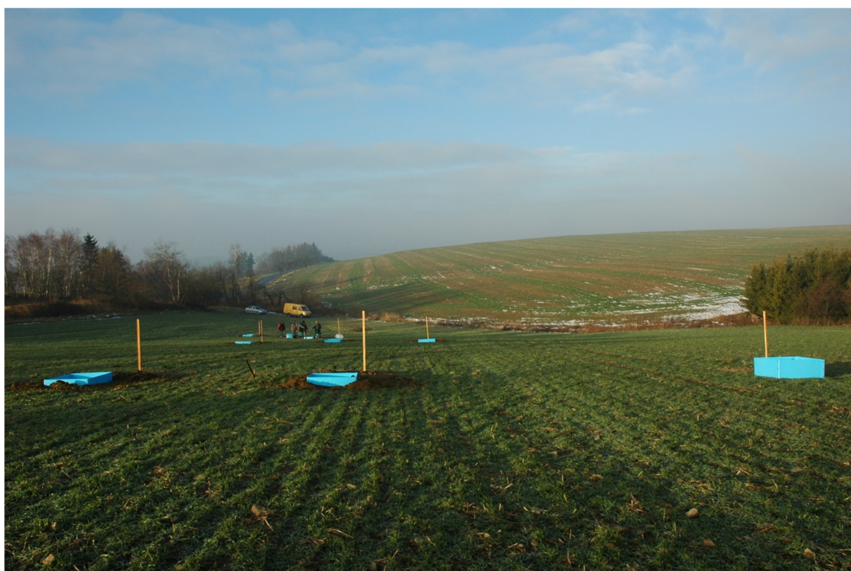
Obr. 22 Instalace odtokových parcel v experimentální lokalitě Větrkovice
