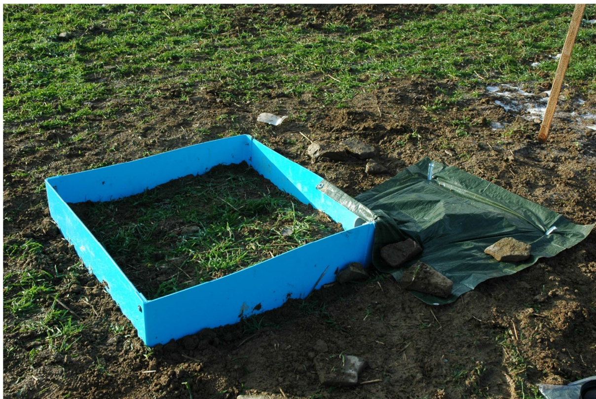
Obr. 20 Instalovaná odtoková parcela
