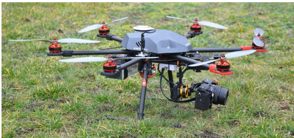
Obr. 28 Hexakoptéra Tarot 690 (Smelík et al, 2016)
