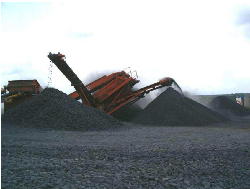
Obrázek 1.10: Drcení a třídění R-materiálu [11]
