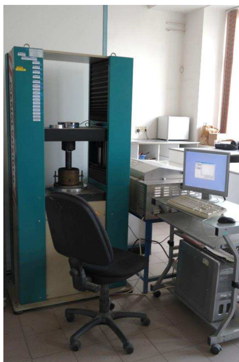
Obrázek 2.10: Zkušební lis InfraTest [1]
