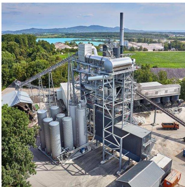
Obrázek 1.7: Stacionární obalovna, BENNINGHOVEN [7]
