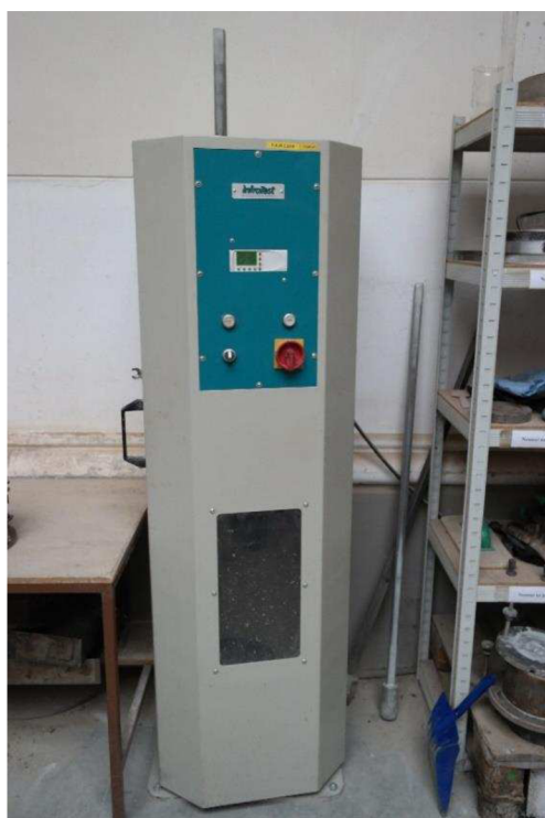
Obrázek 2.9: Zhutňovací přístroj InfraTest [1]
