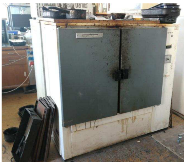
Obrázek 2.5: Horkovzdušná sušící komora [1]
