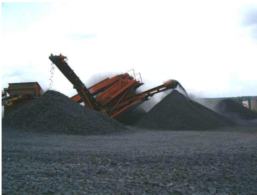
Obrázek 1.10: Drcení a třídění R-materiálu [11]
