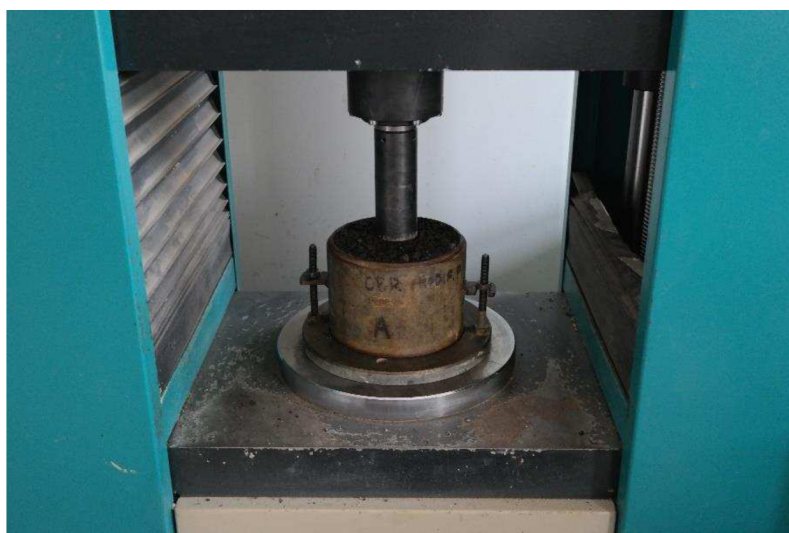
Obrázek 2.11: Průběh zkoušky IBI [1]
