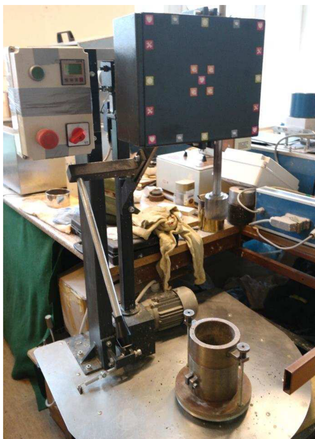
Obrázek 2.6: Hutnicí přístroj Proctor Standard [1]
