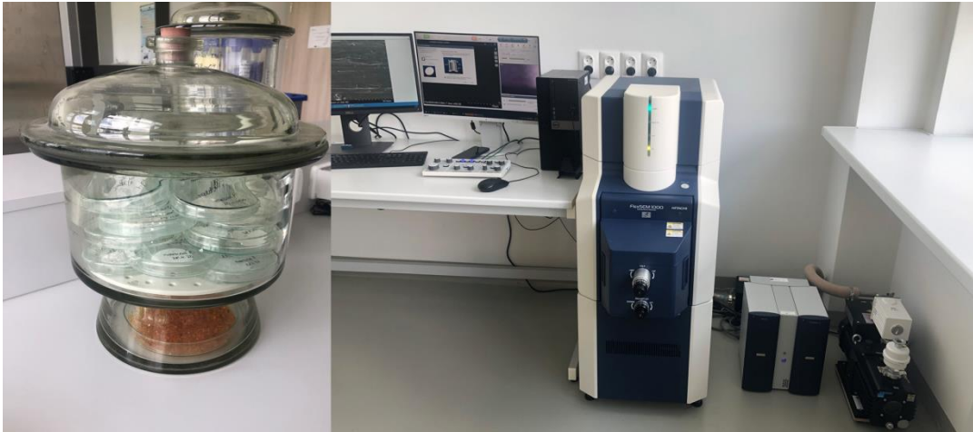
Obrázek 17: Vzorky umístěné v exsikátoru (vlevo); SEM HITACHI FlexSEM 1000 (vpravo) (zdroj vlastní – upraveno)
