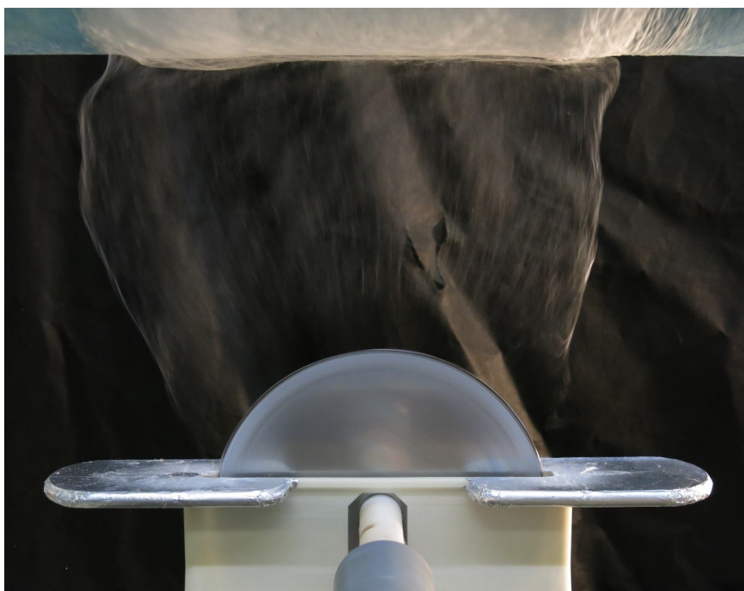
Obr. 6.13 Disková elektroda se stínící rovinou
