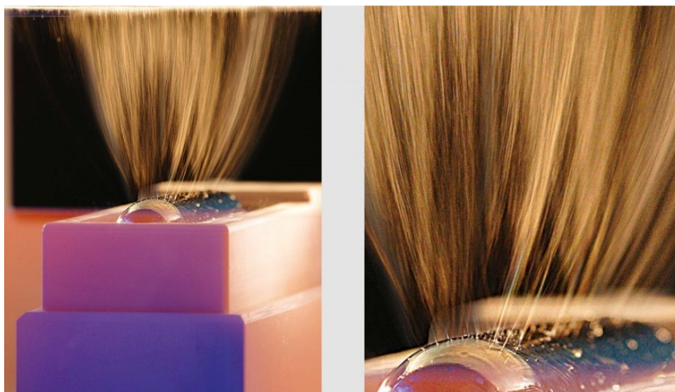
Obr. 1.3 DC electrospinning z volné hladiny, NANOSPIDER™ [5]
