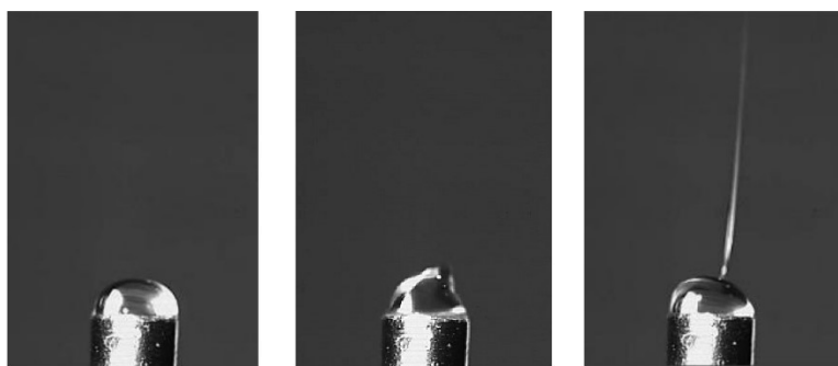
Obr. 1.1 Tvorba trysky působením elektrostatického pole [4]
