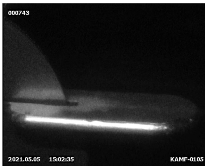
Obr. 7.2 Stínící rovina, snímek z korónové kamery
