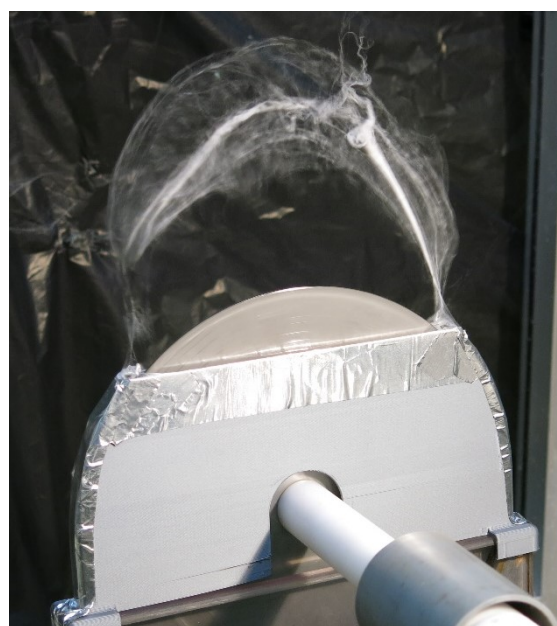
Obr. 6.12 Vlečka strhovaná v důsledku nevhodné konstrukce elektrody
