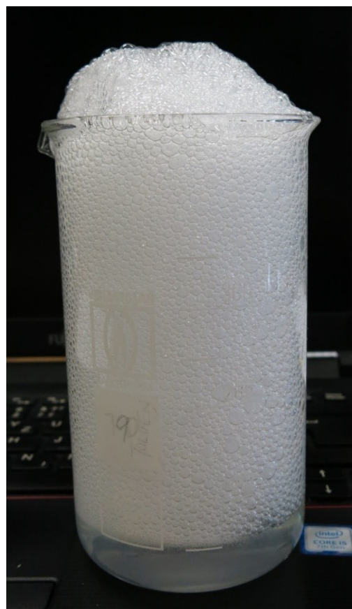
Obr. 6.9 Napěněný polymerní roztok PVA v externím zásobníku
