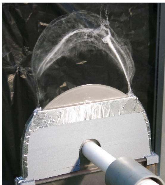
Obr. 6.12 Vlečka strhávaná v důsledku nevhodné konstrukce elektrody
