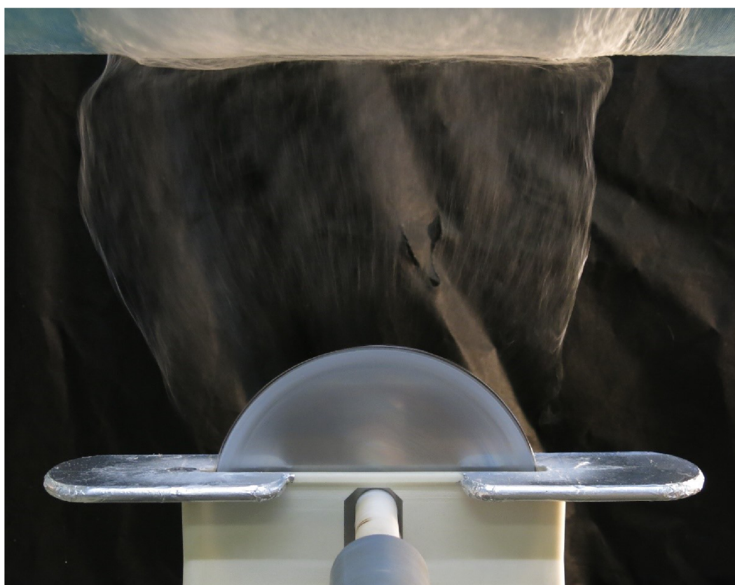
Obr. 6.13 Disková elektroda se stínicí rovinou
