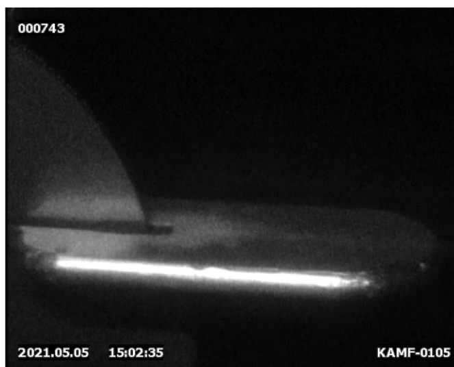
Obr. 7.2 Stínící rovina, snímek z korónové kamery
