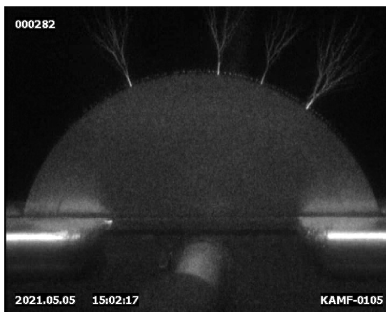
Obr. 7.1 Korónové výboje na elektrodě, snímek z korónové kamery
