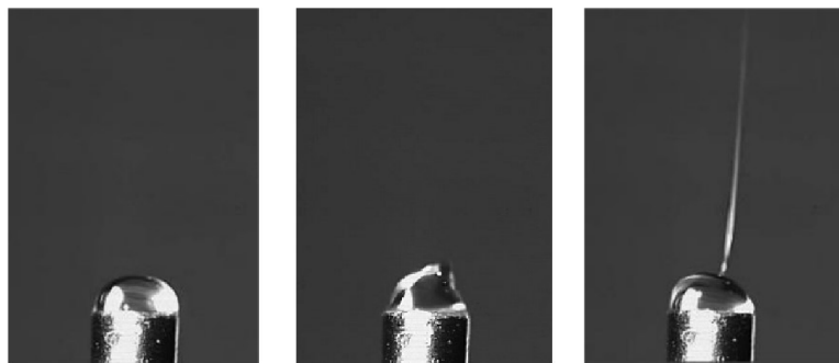
Obr. 1.1 Tvorba trysky působením elektrostatického pole [4]
