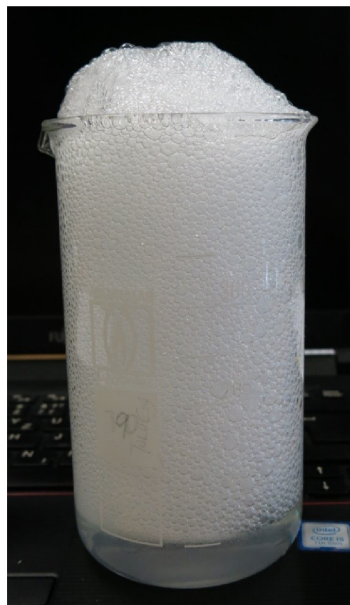
Obr. 6.9 Napěněný polymerní roztok PVA v externím zásobníku
