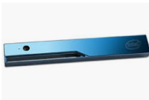
Obr. 18 Ukázka stylu zaznamenávání hloubky (vlevo) a samotná kamera R200 (vpravo) [31]
