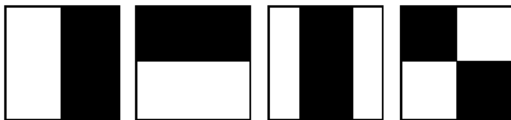
Obrázek 15 - Příklady Haar-like feature kernelů (vyhledání vertikální hrany, horizontální hrany, rovné linie a diagonální linie)
