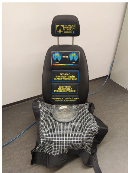
Obrázek 4.6: Umístění plošného snímače tlaku a indentoru při validačním experimentu
