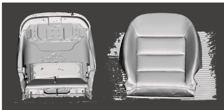
Obrázek 2.1: Obě poloviny hrubých naskenovaných dat ve formátu .stl
