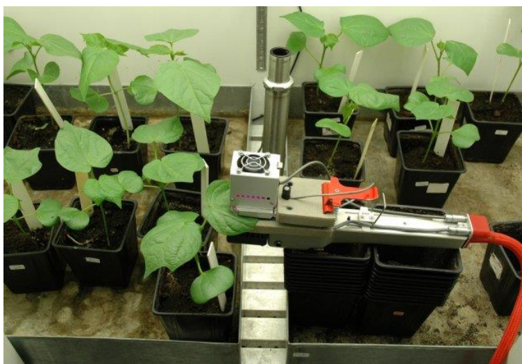
Obrázek 15: Ukázka měření přístrojem LCpro+
