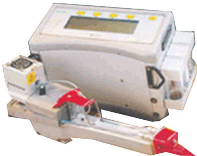
Obrázek 14: LCpro+ (přenosný přístroj na měření výměny plynů, s měřicí komůrkou)
