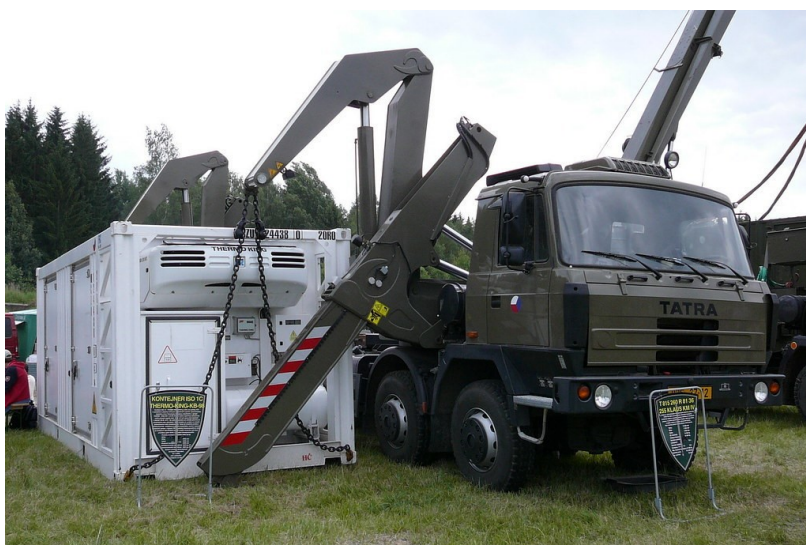
Obrázek č. 2.1 – kontejnerový vůz na klasickém podvozku T 815
