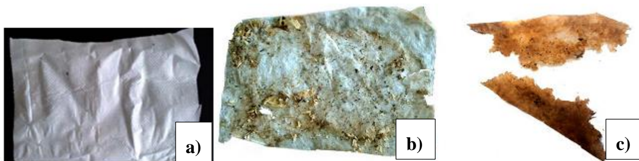
Obrázek 17: Průběh degradace PHB nanotextilie; a) 0 den b) 3. den c) 8. den testování
