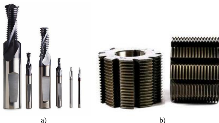
Obr. 11 Hřebenové válcové závitové frézy – a) stopkové, b) nástrčné [31].
