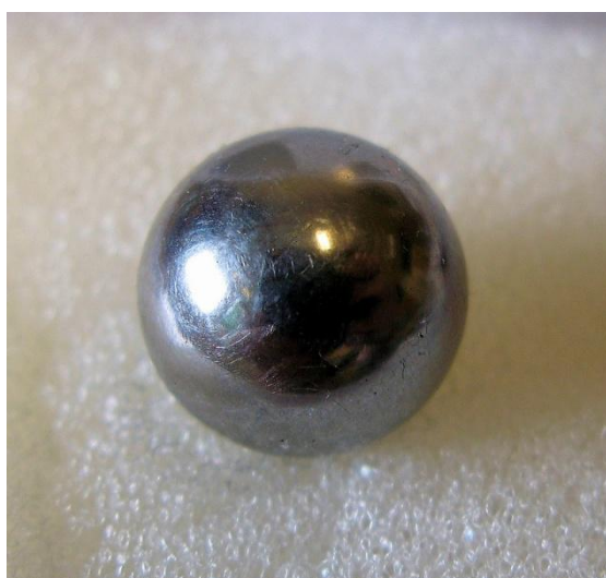
Obr. 36 Kulička indukčně kaleného KŠ.
