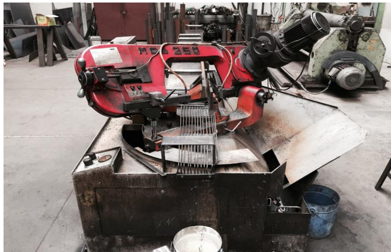
Obr. 4.6 Automatická pásová pila BIANCO Mod. 350 Aut. 60°.
