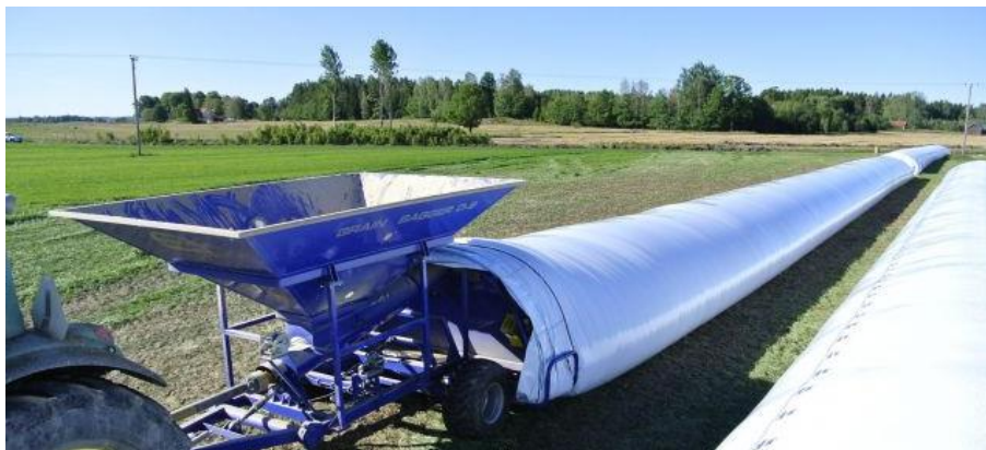
Obr. 1.10 Vak naplněný zrnem – plnič zrna Grain Bagger D-9.
