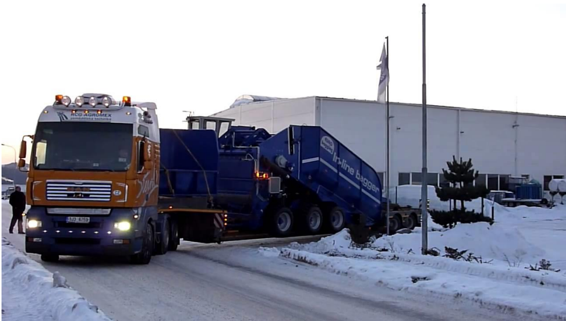
Obr. 6.2 Přeprava stroje pomocí hlubinného návěsu.
