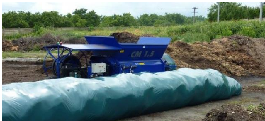
Obr. 1.7 Kompostový vak - kompostovací lis CM 1,5.
