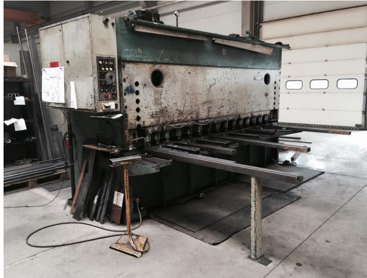
Obr. 4.12 Tabulové nůžky s hydraulickým pohonem CNTA 3150/16A.
