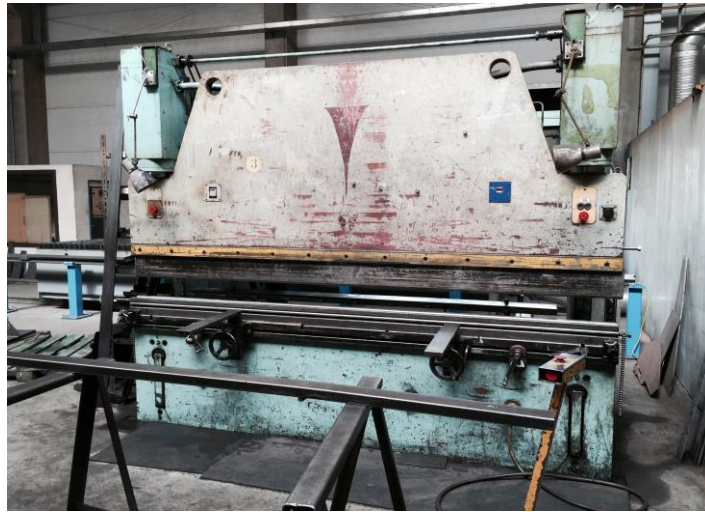
Obr. 4.13 Ohraňovací lis CTO 160, Strojárne Piesok, a.s.
