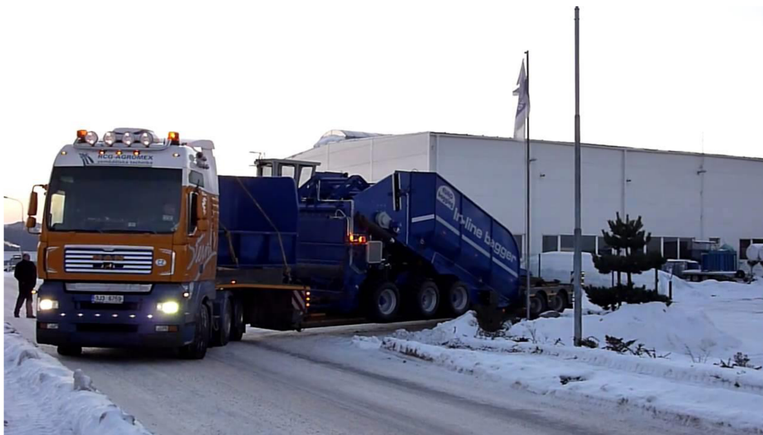
Obr. 6.2 Přeprava stroje pomocí hlubinného návěsu.
