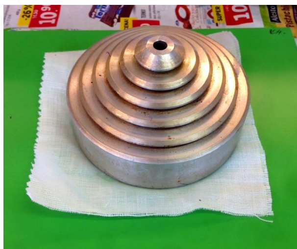
Obr. 15 Hliníkový blok použitý jako tepelný zdroj při testování odolnosti povrchu proti působení vlhkého tepla
