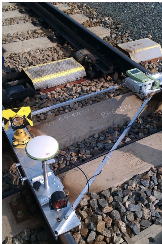
Obr. 6.2 Vozík na meranie priebehu koľaje
