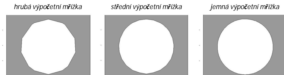
Obr. 4.23 Vliv použité výpočetní mřížky na rozlišení geometrie profilu škrťící trati
