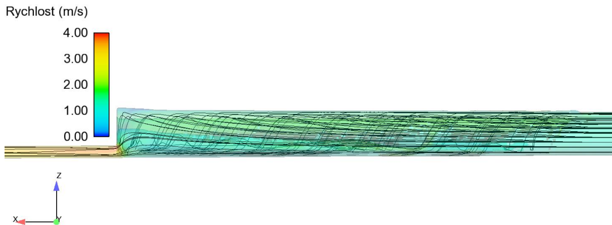
Obr. 4.39 Proudnice v OK dle ATV-A 111 – střední výpočetní mřížka – RNG k- \epsilon model
