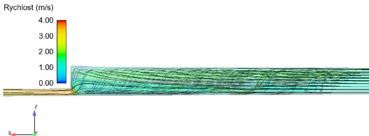
Obr. 4.39 Proudnice v OK dle ATV-A 111 – střední výpočetní mřížka – RNG k-ε model
