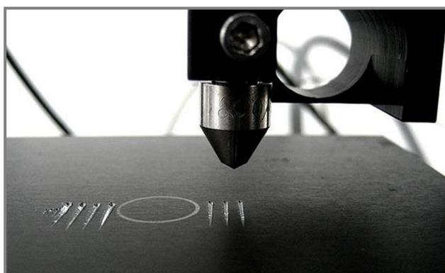
Obr. 14 Vrypy zhotovené pomocí scratch testeru [10]
