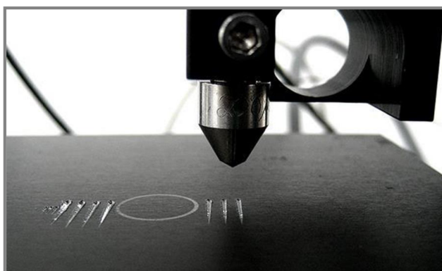
Obr. 14 Vrypy zhotovené pomocí scratch testeru [10]
