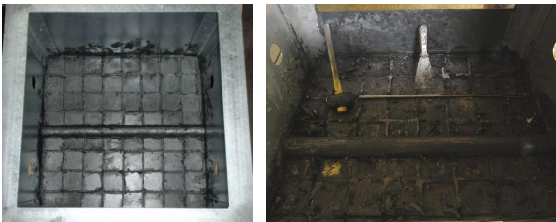
Obr. 51 Fotografie ze stavby akumulčního jádra. Konglomerát granitových kostek a TVG. (Lachman et al., 2014)
