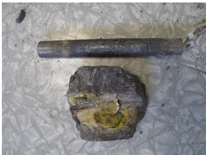
Obr. 38 Fotografie topné patrony a okolního TVG pořízená při rozebírání granitového bloku (ÚSMH).
