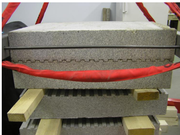
Obr. 27 Fotografie granitového bloku se zazubenu spárou (ÚSMH)
