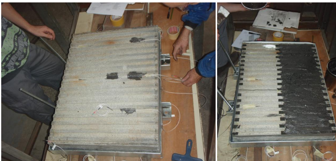
Obr. 28 Příprava experimentu s granitovým blokem. Vlevo příprava monitorovacích teploměrů; vpravo nanesení TVG do zazubené spáry. (ÚSMH)
