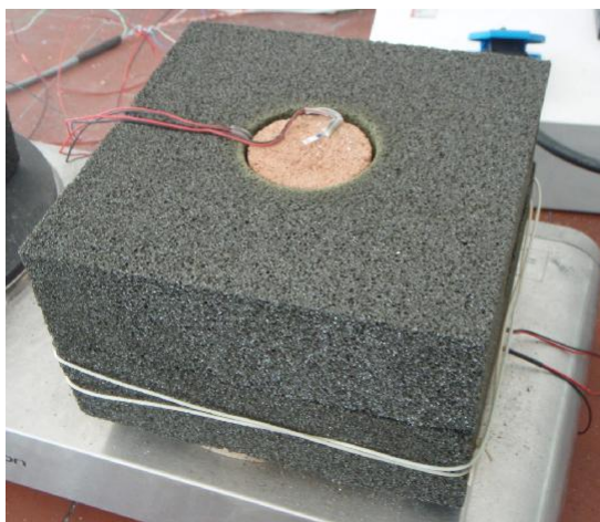
Obr. 21 Experimenty prohřívání válečků a) vlevo ilustrační fotografie prohřívajícího vzorku (pískovec) b) rozměry válcového horninového vzorku s mini-vrtem (žlutě). (Hladký, 2012)
