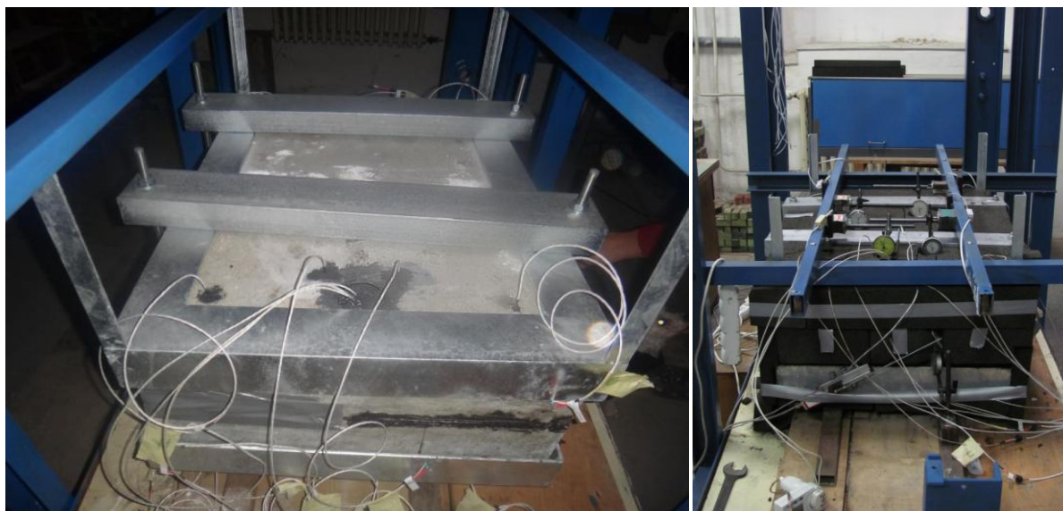
Obr. 30 Fotografie z přípravy testu tepelně vodivého geopolymery na granitovém bloku. Vlevo granitový blok v ocelovém rámu s přívody k topidlu a teploměrům; vpravo již osazený blok izolací a měřící aparaturou (foto ÚSMH)
