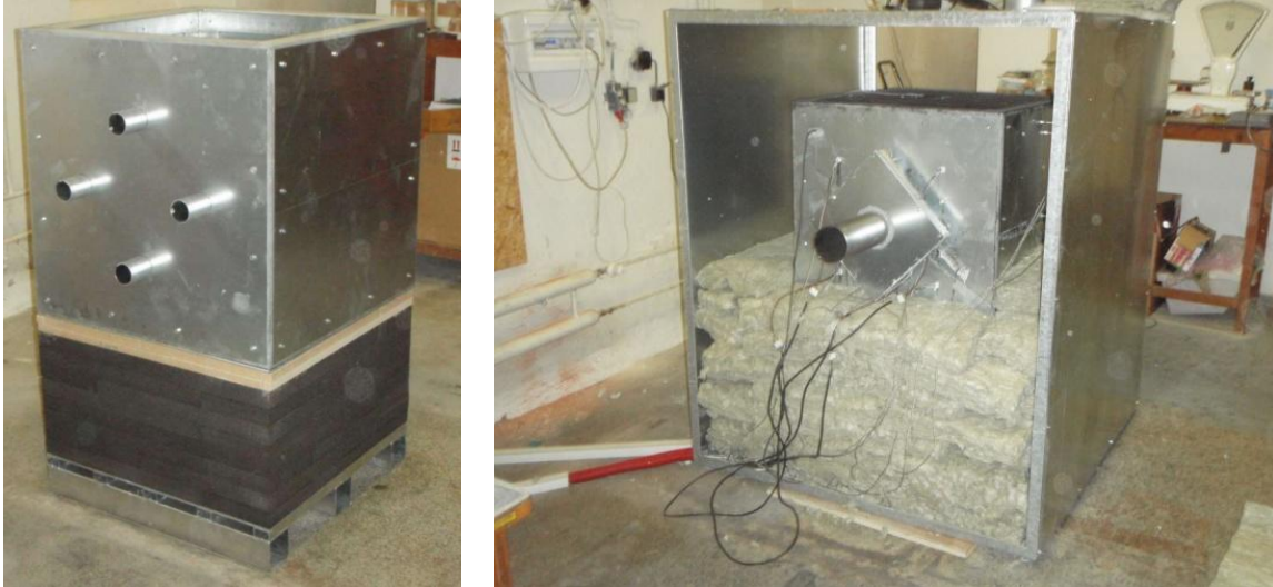
Obr. 53 Fotografie z průběhu výstavby prototypu tepelného úložiště. Vlevo jádro úložiště bez rozdělovacího prvku vzdušného výměníku, vpravo již probíhá zaizolování akumulárního jádra i spolu s prvky výměníku.
