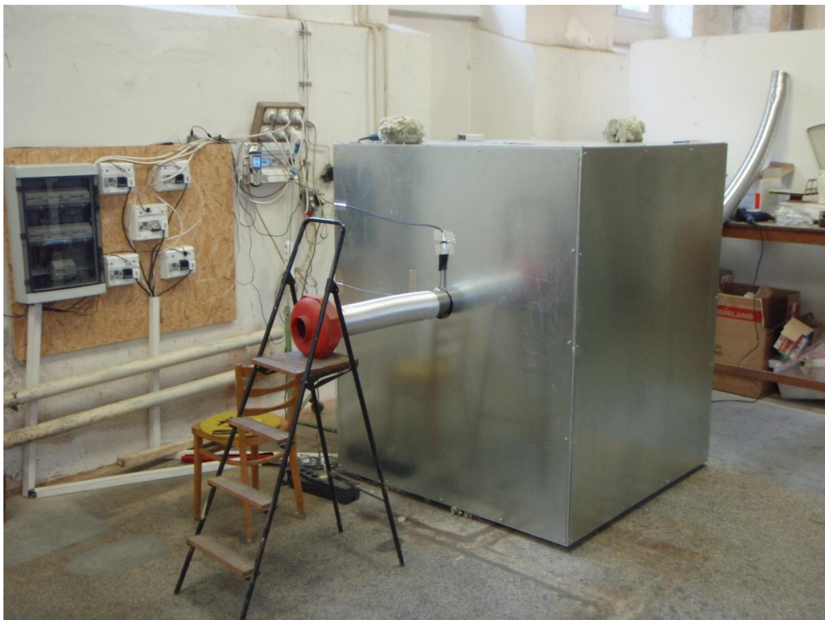
Obr. 54 Fotografie konečné podoby prototypu tepelného úložiště s TVG.
