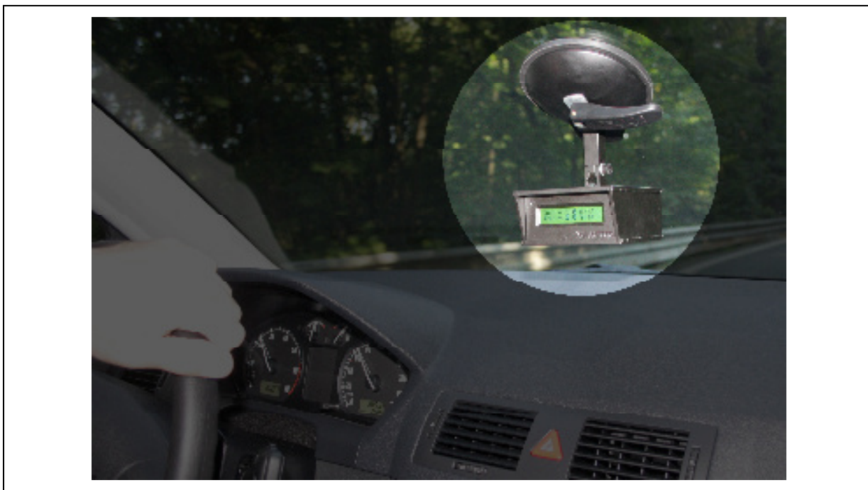
Obr. č. 5.6 – Umístění měřicího přístroje XL Meter na předním skle vozidla č. 2 při jízdních zkouškách
