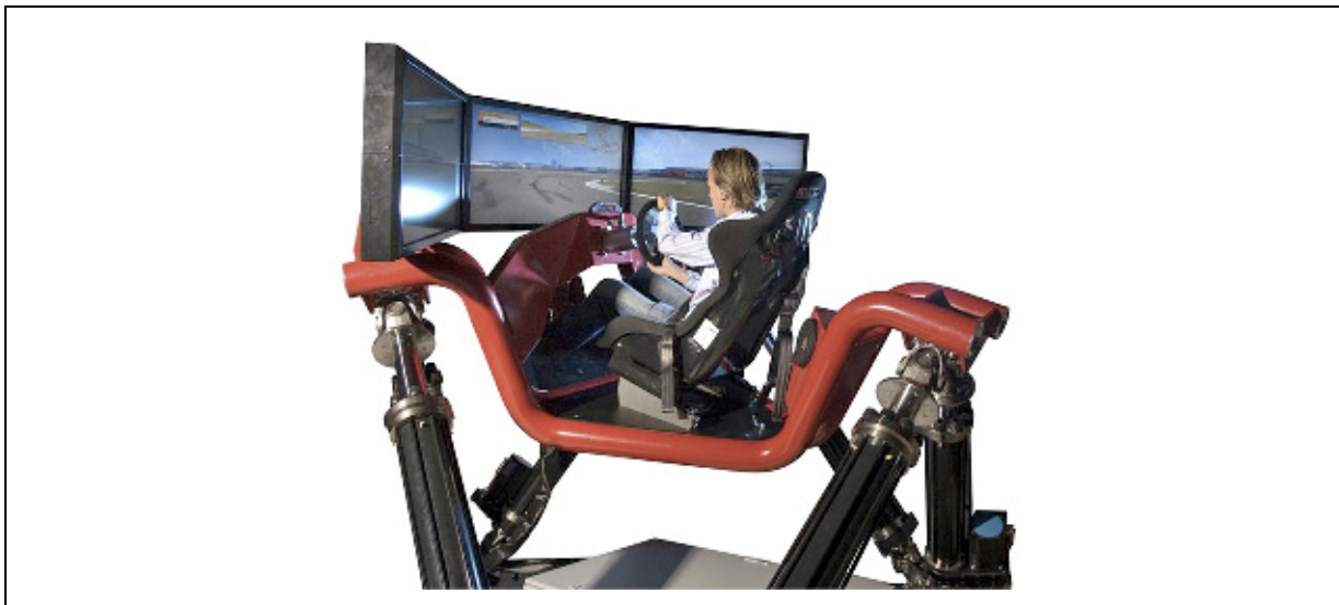
Obr. č. 2.2 – Simulátor závodního vozu Cruden Hexanech tvořený hydraulickým triodem
