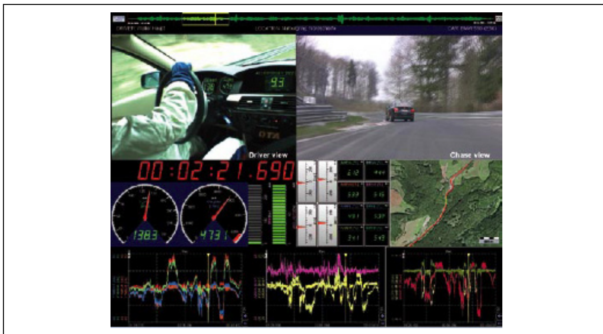
Obr. č. 1.24 – Využití obrazového záznamu při analýze jízdních parametrů vozidla [8] obrazový záznam měřeného objektu (nahore), grafické zobrazení naměřených dat (dole)
