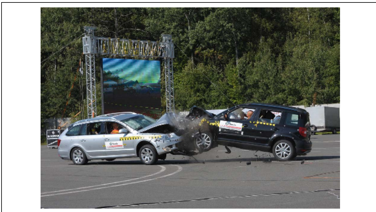
Obr. č. 2.4 – Simulace dopravní nehody. Vozidla jsou opatřena měřicími systémy a nehodový děj je snímán vysokorychlostními kamerami pro následnou detailní analýzu střetu.
