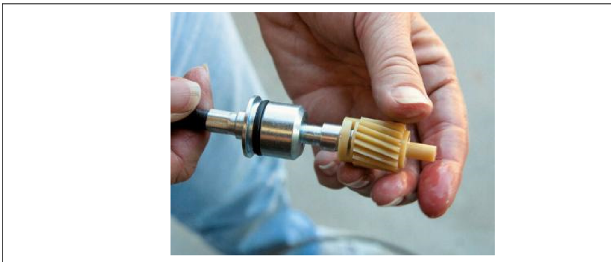
Obr. č. 1.2 – Mechanický náhon bowdenu u mechanického snímání ujeté vzdálenosti a rychlosti vozidla
