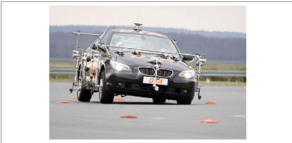
Obr. č. 2.1 – Vývojové jízdní zkoušky, vozidlo je osazeno měřicími systémy pro snímání jízdních parametrů vozidla
