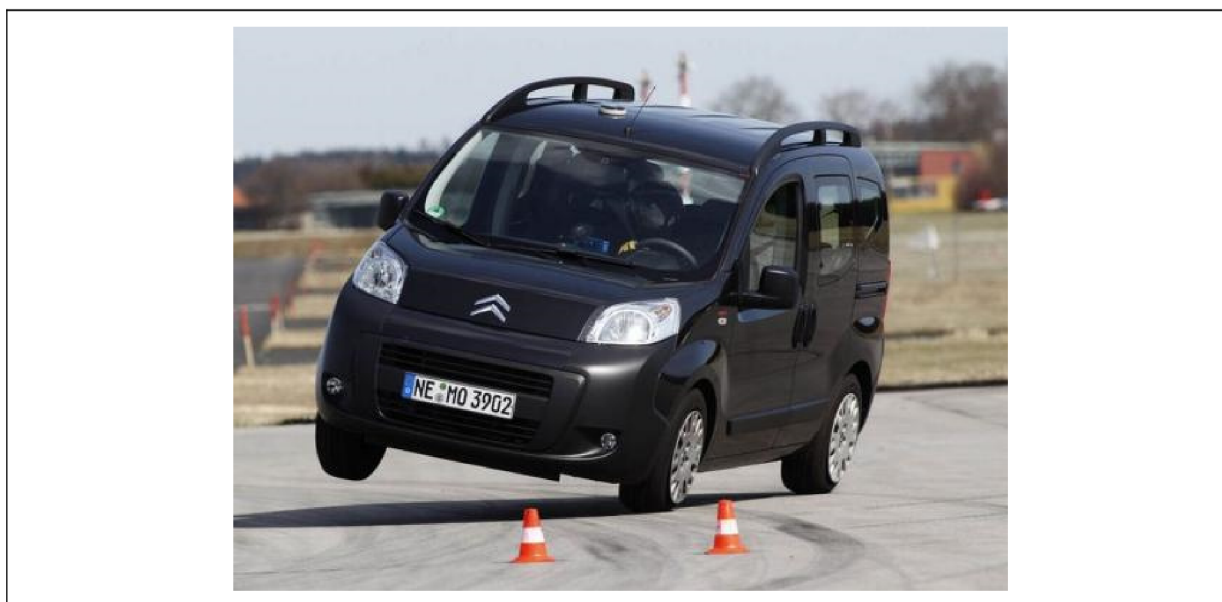
Obr. č. 4.2 – Vozidlo při vyhýbacím manévru tzv. losím testu.
