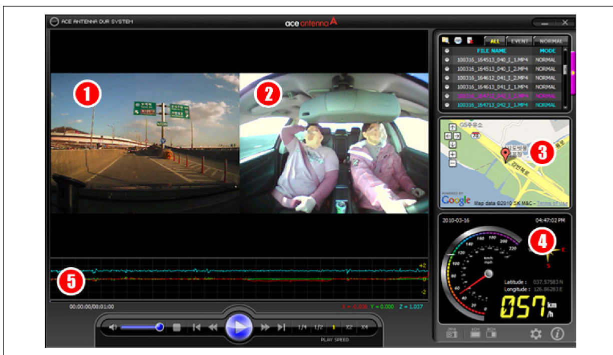
Obr. č. 2.5 – Záznam z černé skříňky – uživatelské zobrazení: 1-obrazový záznam prostoru před vozidlem, 2-obrazový záznam posádky, 3-poloha vozidla, 4-jízdní parametry a údaje z GPS, 5-průběhy zrychlení ve třech osách
