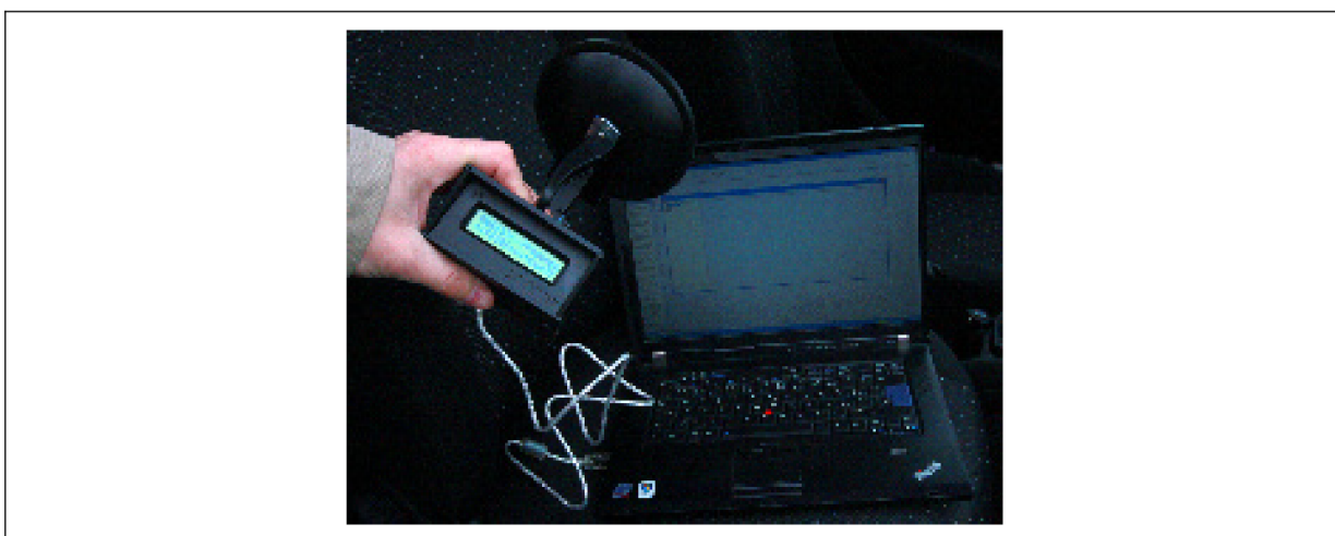
Obr. č. 1.20 – XL Meter™ Pro Inventure, Inc. při zálohování naměřených dat do počítače
