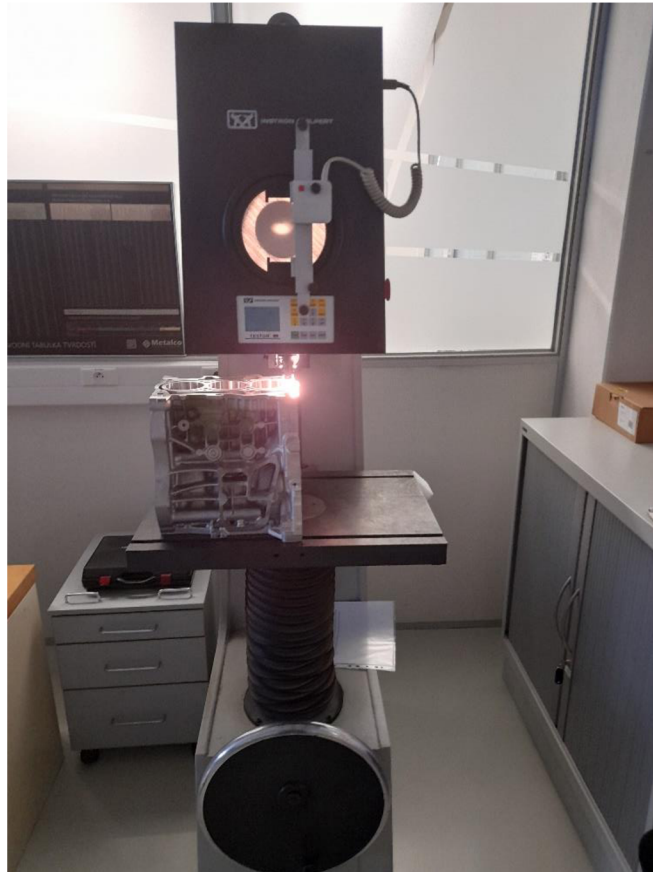
Obr. 11 – Měřicí přístroj INSTRON WOLPERT - tvrdoměr
