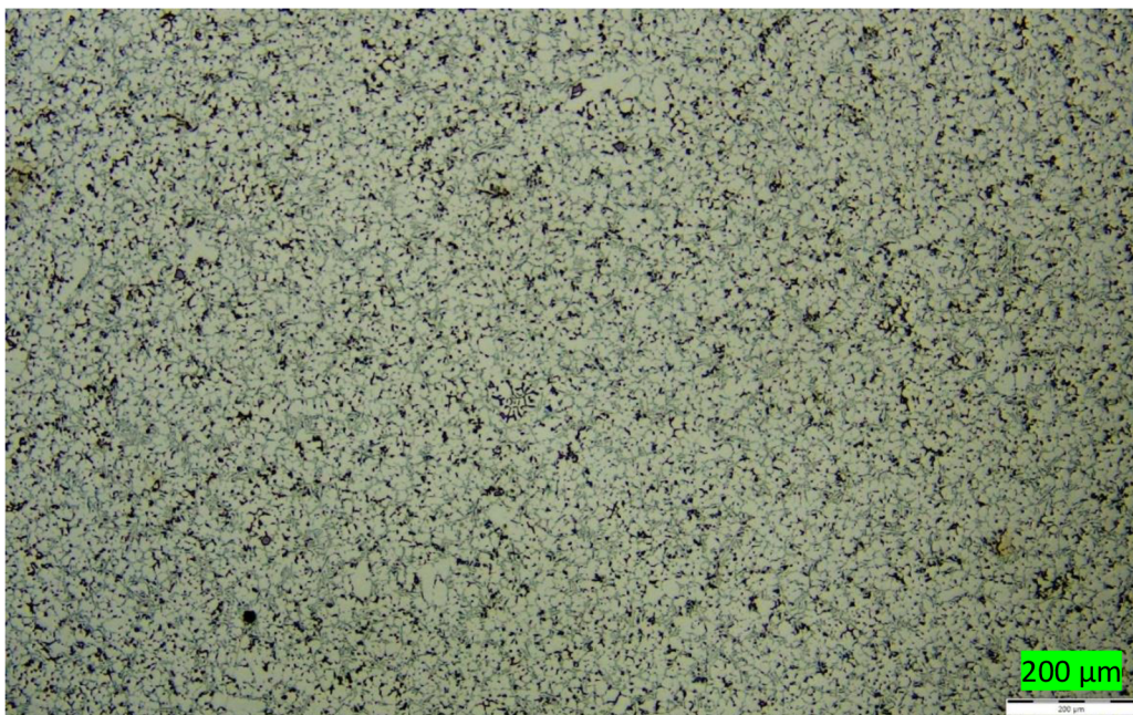
Obr. 26 - Mikrostruktura bloku motoru, vzorek C, blok motoru č. 7, zvětšeno 100x (tepelně zpracováno, ohřev na teplotu 250 °C po dobu 3 hodin)
