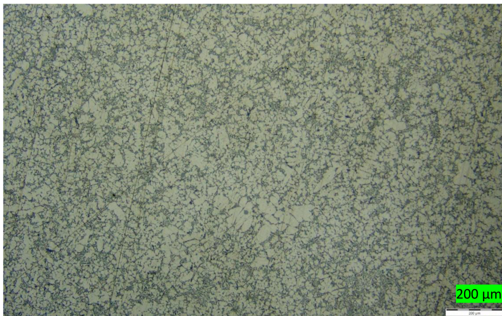
Obr. 20 - Mikrostruktura bloku motoru, vzorek A, blok motoru č. 1, zvětšeno 100x (bez tepelného zpracování)
