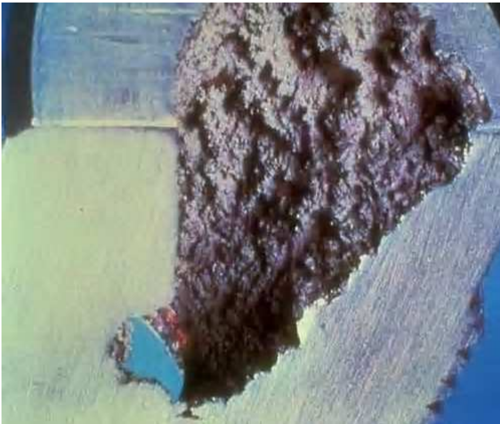
Obr. 2.1.1 - Typický vhled povrchu, na který působí kavitace.[]
