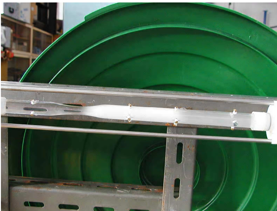
Obr. 4.3.2.1 – Ukázka kavitující trysky. []
