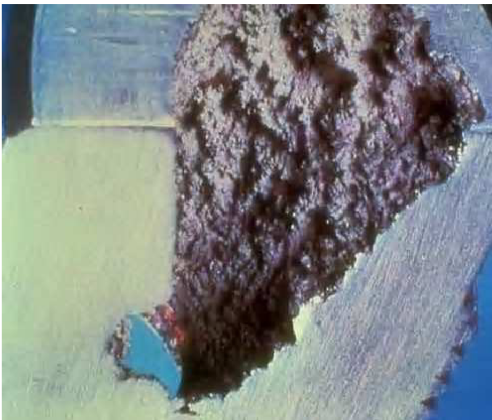
Obr. 2.1.1 - Typický vhled povrchu, na který působí kavitace. []
