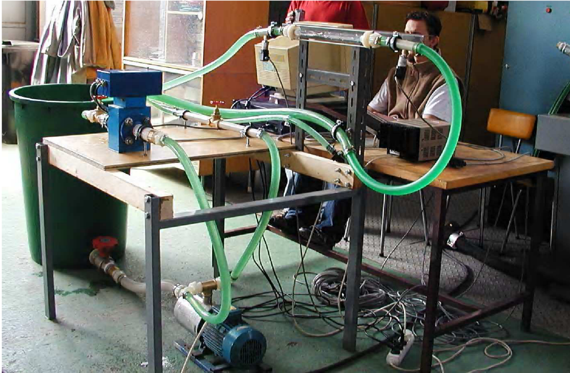
Obr. 4.2.1 – Fotografie z laboratoří se zapojenou tryskou ve standu.
