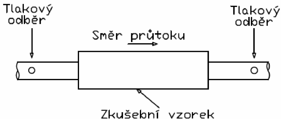
Obr. 4.2.3.1 – Tlakové odběry na zkušebním vzorku.
