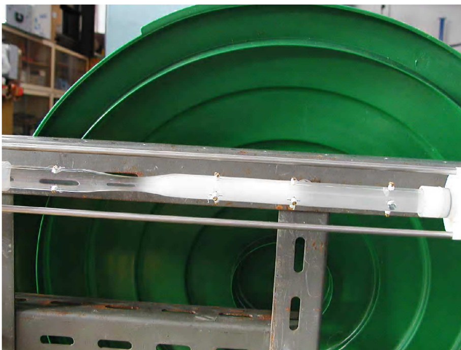
Obr. 4.3.2.1 – Ukázka kavitující trysky. []
