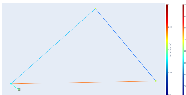
Obr. 2.5: Ukázka powerflow grafu, kde podle zatížení výstup je znázorněn dle barevného rozdělení.
