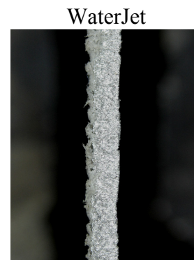
Obr. 52 Velikost otřepů vzorku zhotoveného vodním paprskem.
