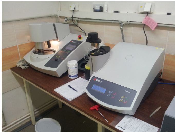
Obr. 44 Přístroje využitě při tvorbě metalografického výbrusu.
