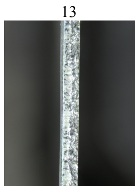
Obr. 51 Velikost otřepů vzorku s fólií umístěnou na horní straně řezu.
