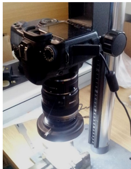
Obr. 43 Sestava pro focení vzorků.
