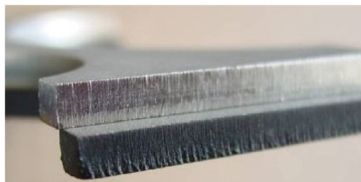
Obr. 17 Řezná hrana ovlivněná typem použitého řezného plynu [1].
