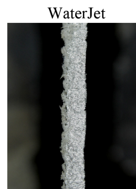
Obr. 52 Velikost otřepů vzorku zhotoveného vodním paprskem.
