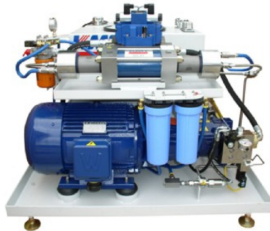
Obr. 23 Vysokotlaké čerpadlo s multiplikátorem [46].
