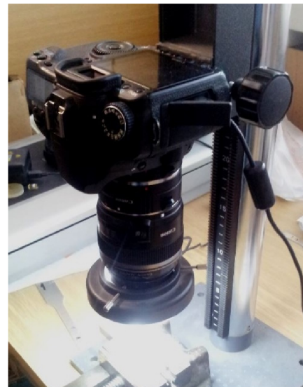
Obr. 43 Sestava pro focení vzorků.
