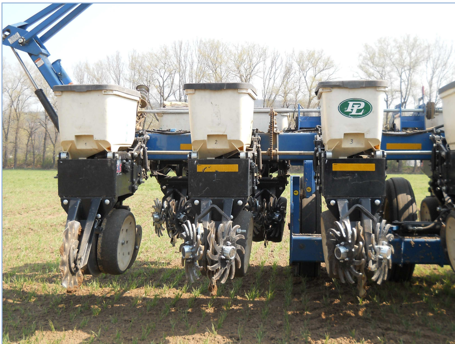
Obrázek 11 Detail secího ústrojí pro výsev dvouřádků (zdroj: archiv autora)
