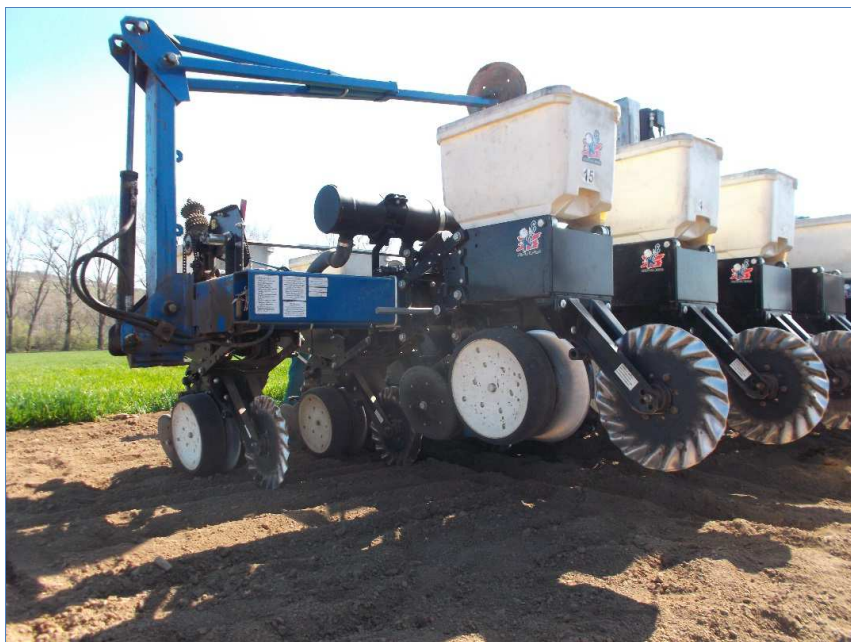
Obrázek 9 Detail nastavení secího stroje pro setí klasických řádků (0,75 m) (zdroj: archiv autora)
