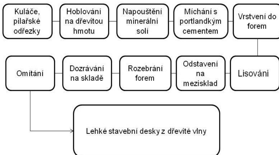
Obrázek 2: Schéma výrobního procesu (7)
