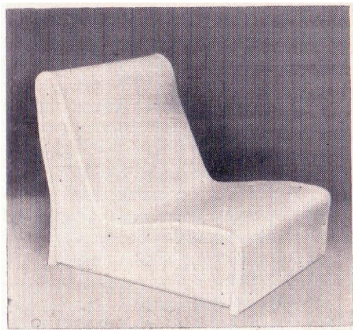
7 – Opracovaná kostra křesla z lepených desek pěnového polyuretanu potažená polyuretanovou pěnou (molitanem). Vyobrazeno: Základní pracovní operace, in: František Haškovec, Nábytek z pěnového polystyrenu: výroba a opravy , Praha 1982, s. 53. (reprofoto: Vilém Urban).
