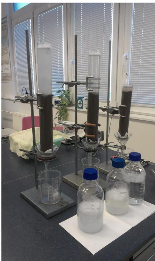
Obr. 5. Aparatura pro infiltrační experiment – jímání filtrátů jednotlivých hasebních prostředků (vlastní foto).
