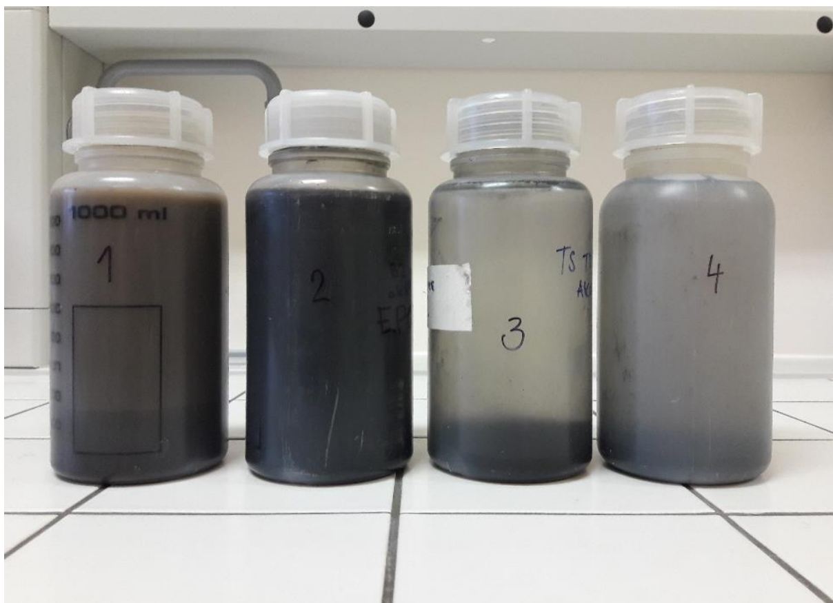
Obr. 6. Výluhy jednotlivých vzorků biocharu po 24 hodinách třepání v pořadí zleva SG_M, BC_M, BA, BB (vlastní foto).
