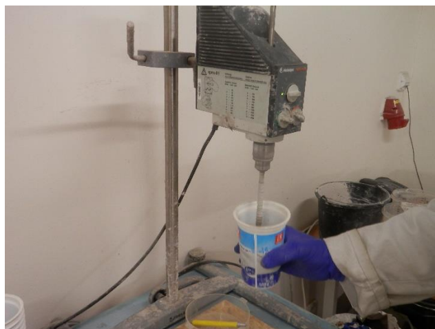
Obrázek 24: První fáze – smíchání cementu s aktivátorem [Autor BP]
